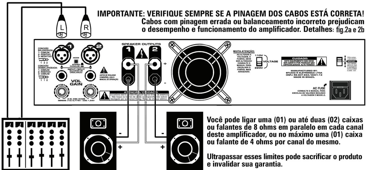
A figura acima mostra o diagrama básico para as ligações na traseira do seu amplificador num sistema de som.
