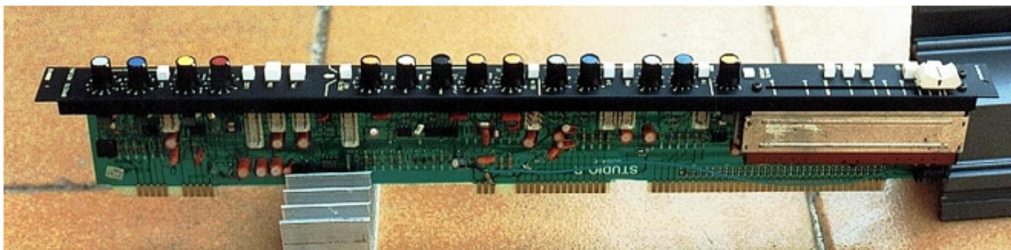
Módulo 8004. Sub Grupo com somador balanceado, 3 níveis de Mute, equalizador paramétrico endereçável com frequência e Q variáveis, PFL, SOLO, Volta para máquina de 32 pistas e 10 Auxiliares
