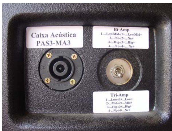
Foto do Painel Traseiro da MA3, Detalhando a Chave Comutadora BI/TRI AMP.
